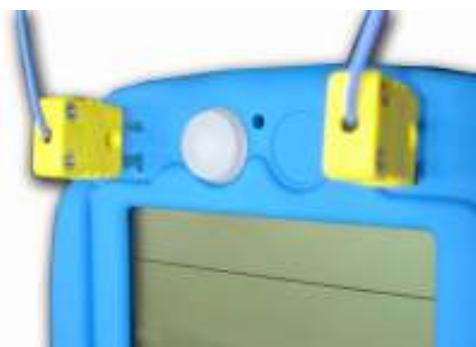
Podłączenie czujników temperatury
